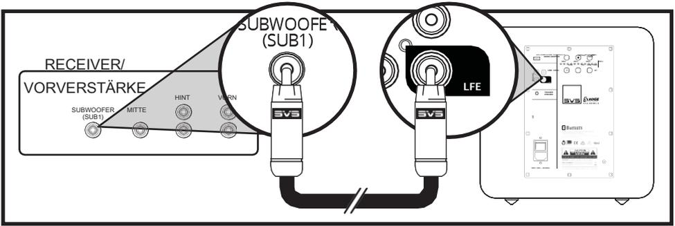
**Line-Pegel-Anschluss – Stereoreceiver oder Vorverstärker linke/rechte Kanäle**
