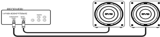
Sollten Sie mehr Subwoofer als Sub-Ausgänge von Ihrem AV-Receiver haben, bietet die Nutzung eines RCA-Splitters oder eines RCA-Y-Adapters eine einfache Lösung zur Teilung des Subwoofer-Ausgangs. Dies wird üblicherweise für einen Anschluss mehrerer Subwoofer bei nur einem Sub-Ausgang empfohlen.
