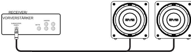
Eine weitere Möglichkeit ist die Nutzung der linken und rechten RCA-Ausgänge am SB-3000 für eine Verbindung von zusätzlichen Subwoofern in Reihe. Hier ist wichtig, passende Aus- und Eingangsklemmen zu nutzen. Wenn Sie beispielsweise RCA-Eingänge nutzen, stellen Sie sicher, dass auch RCA-Ausgänge für den Anschluss des nächsten Subwoofers in Reihe verwendet werden.
