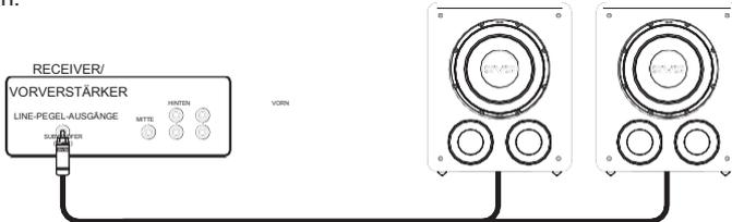
Eine weitere Möglichkeit ist die Nutzung der linken und rechten RCA-Ausgänge am PB-2000 Pro für eine Verbindung von zusätzlichen Subwoofern in Reihe. Hier ist wichtig, passende Aus- und Eingangsklemmen zu nutzen. Wenn Sie beispielsweise RCA-Eingänge nutzen, stellen Sie sicher, dass auch RCA-Ausgänge für den Anschluss des nächsten Subwoofers in Reihe verwendet werden.
