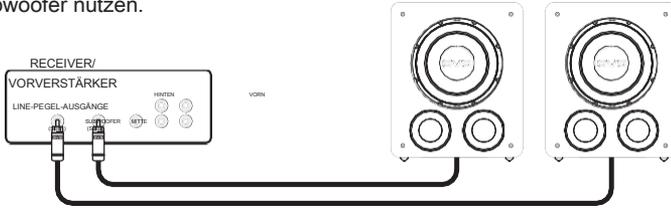
Sollten Sie mehr Subwoofer als Sub-Ausgänge von Ihrem AV-Receiver haben, bietet die Nutzung eines RCA-Splitters oder eines RCA-Y-Adapters eine einfache Lösung zur Teilung des Subwoofer-Ausgangs. Dies wird üblicherweise für einen Anschluss mehrerer Subwoofer bei nur einem Sub-Ausgang empfohlen.
