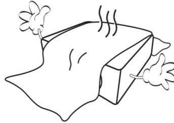
Wenn die Belüftungsöffnungen blockiert sind, kann Überhitzung im Projektor zu einem Brand führen.
